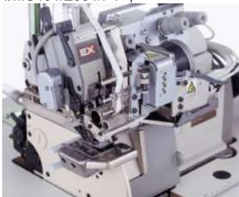
2. Двухигольная четырехниточная краеобметочная машина с устройством механической подачи эластичной тесьмы «PEGASUS M952-52-2X4/D222»
