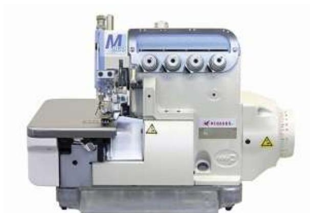
2. Двухигольная четырехниточная краеобметочная машина «SIRUBA 747K-514M2-24/DKKU1-0»
